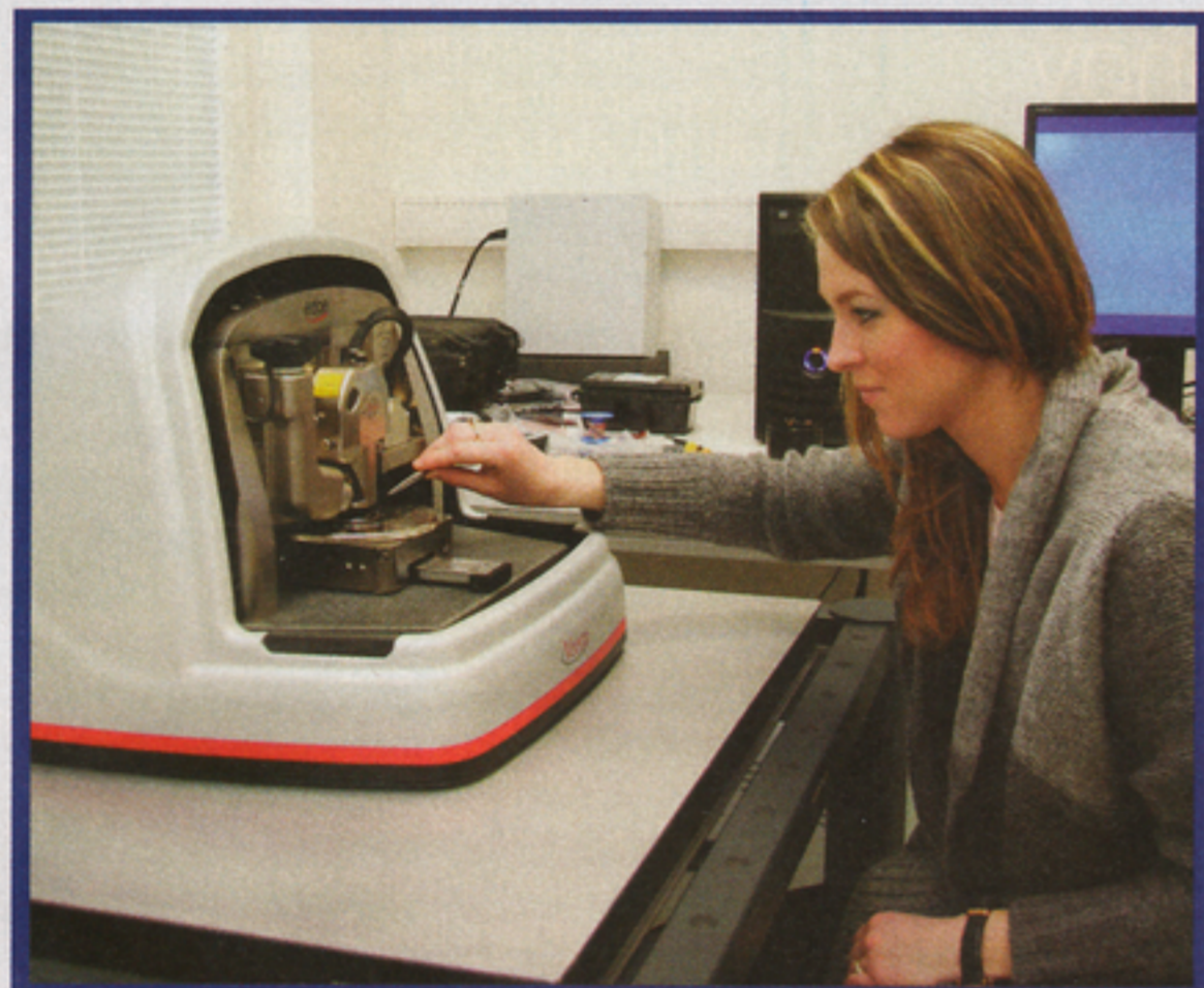
Doktorandka Monika Benkovičová vyhodnocuje vlastnosti nanočastíc pomocou atómového silového mikroskopu.
